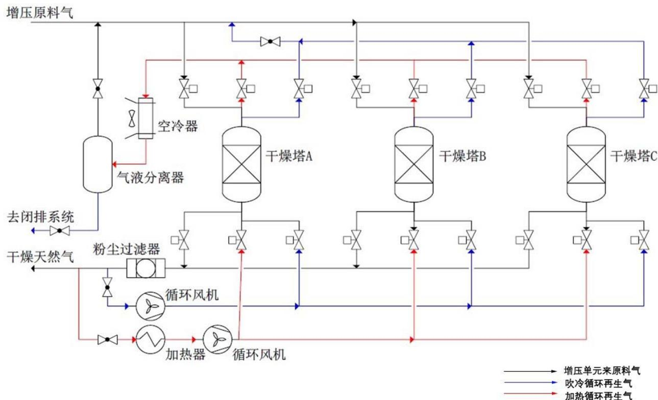
图 3.2-4 原料气脱水单元工艺流程图
