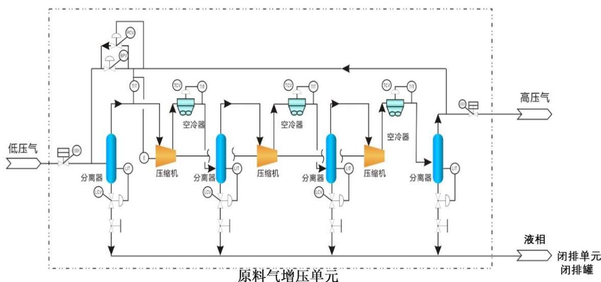
图 3.2-2 原料气增压单元工艺流程图
