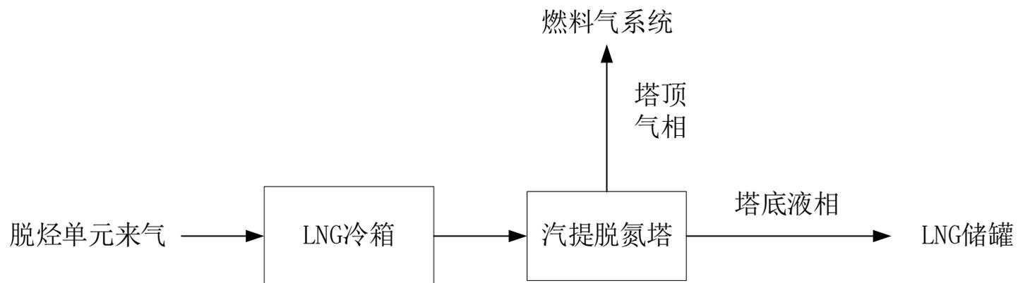
图 3.2-6 低温液化单元工艺流程图
