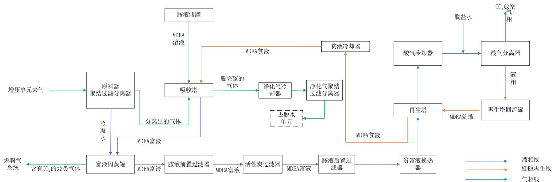
图 3.2-3 原料气脱碳单元工艺流程图
