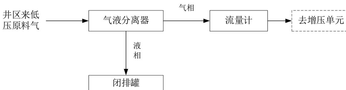
图 3.2-1 原料气气液分离计量单元工艺流程图
