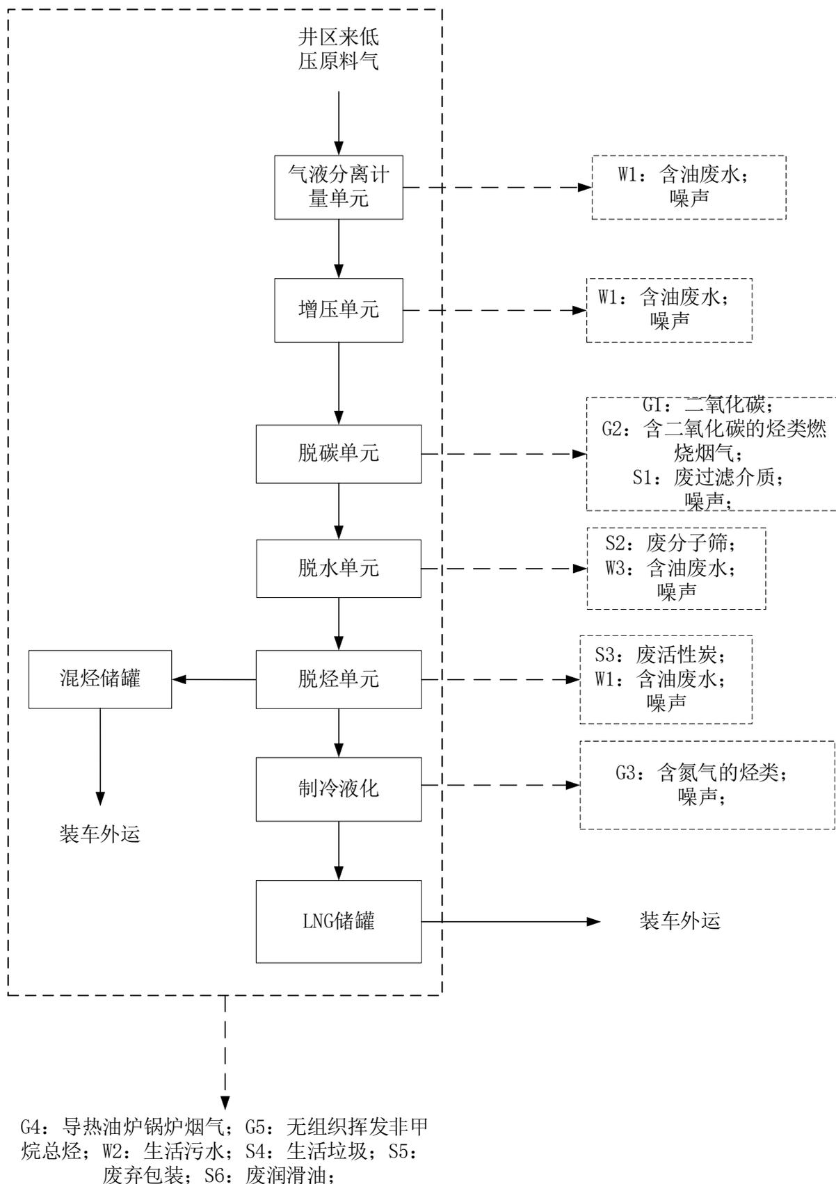
图 3.2-7 总工艺流程图
