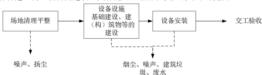
图 3.3-1 施工期施工工艺流程及产污环节示意图
